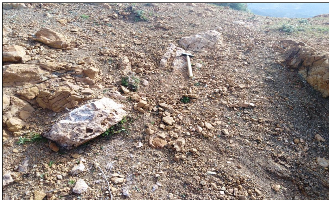
Photo 16: filon de barytine entre une formation argilo-marneuse et calcaire à oolithes. (Région de Belabbés gisement Nord Boucaïd).
