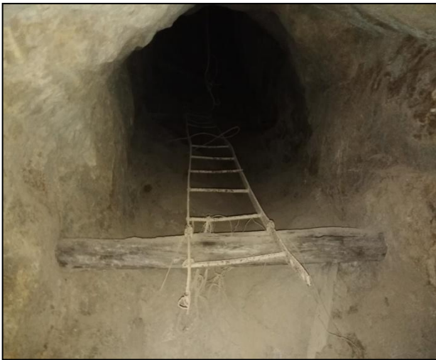
Photo 19:(A) & (B) cheminée de passage dans la galerie du gisement Nord Boucaïd (2021)
