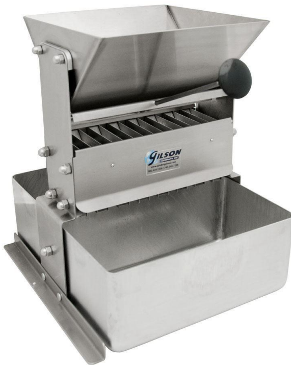
Fig. 6 : L'équipement de scission du fusil Jones.
