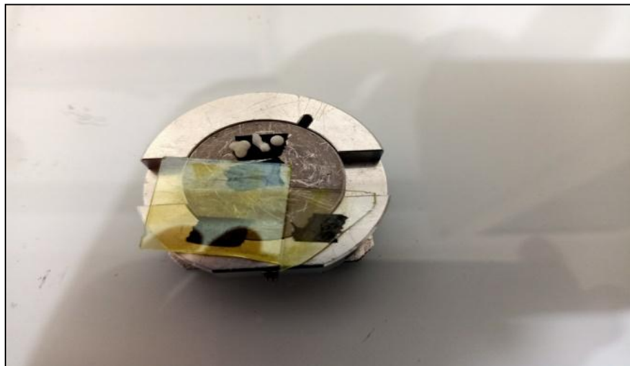
Fig.25 -photographie du plot métallique du microscope a balayage électronique (MEB).
