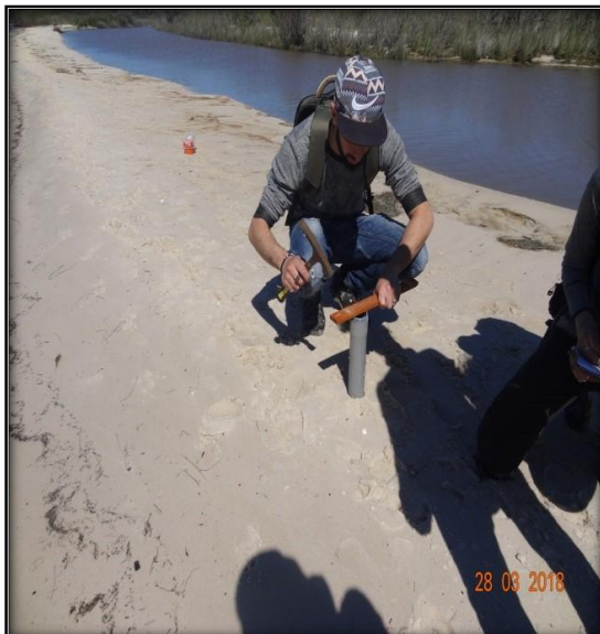
Fig.5 et Fig.6 - Echantillonnage par un carottage
