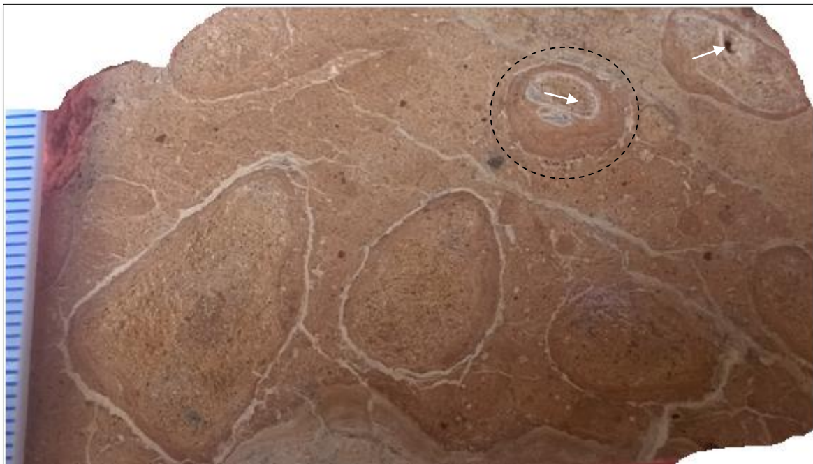
Fig.16 : Caractéristiques diagnostiques de calcrête. L'une des caractéristiques les plus importantes du calcrête vue dans les sections polies est leur texture inhomogène. Les critères caractéristiques de cette image sont la texture de type brèche, les tissus nodulaires, les tissus coagulés avec des peloïdes micritiques.
