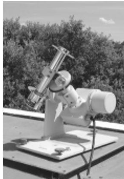
Pyrhéliomètre Eppley : mesure de la composante directe
