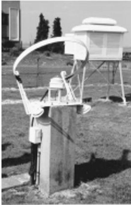
Pyranomètre équipé d'un pare-soleil : mesure de la composante diffuse
