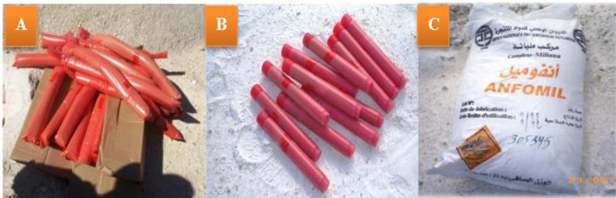
Figure11: les différents explosifs utilisés pour abattre le gypse
