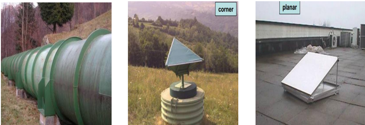
Figure 13: quelque type des réflecteurs artificiels présentant des retours radar stables
