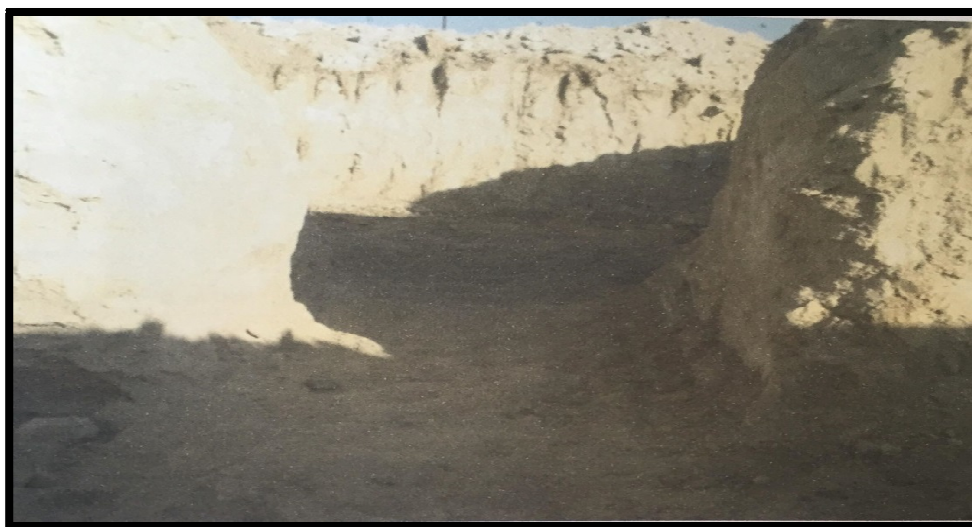
Fig. 35 : Tranchée dans le site montrant son assise représentée par les limons marno-gypseux.
