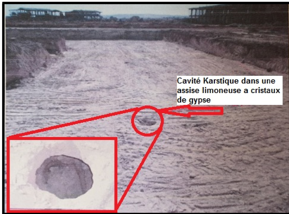
Fig. 27: Cavité Karstique suite a la dissolution du gypse a El Kerma.
