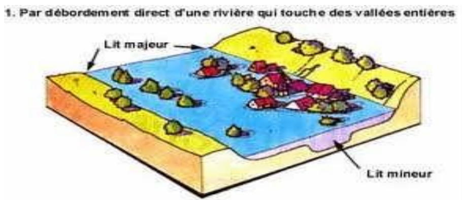
Fig. 7 : Inondation par débordement direct.
