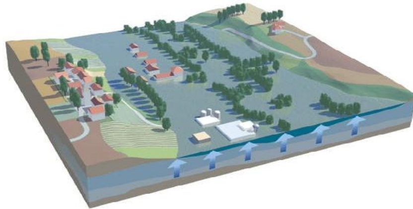
Fig. 6 : Inondation par remontée de nappe phréatique.
