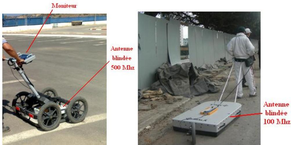
**Fig n°23** : Appareillages Radar effectuant des mesures avec les antennes 500 Mhz et 100 Mhz.
