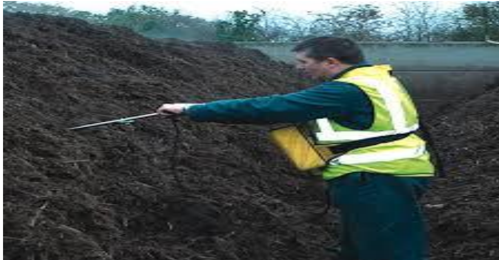
Figure 12: Comment nous mesurons la température
