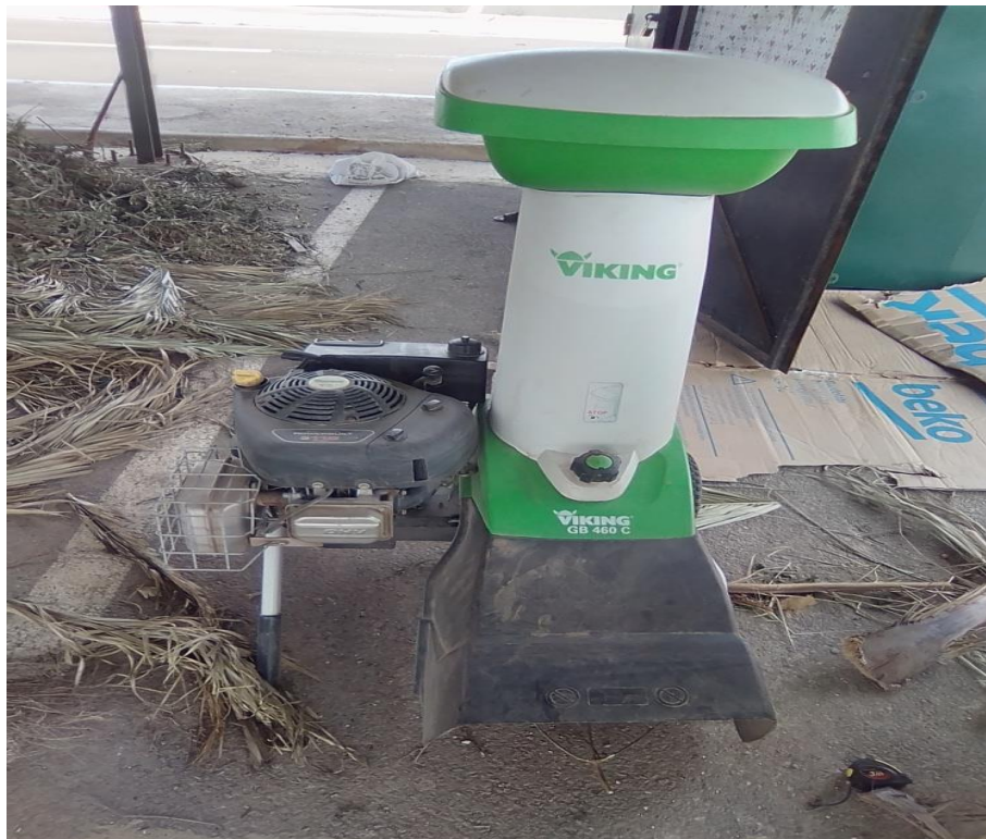
figure 37 : la machine du broyage « le broyeur »
