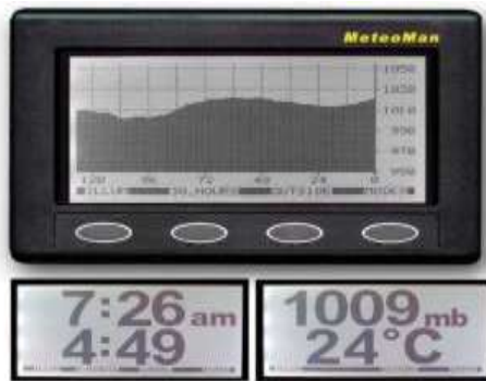
Figure I.11. Le Barographe numérique.
