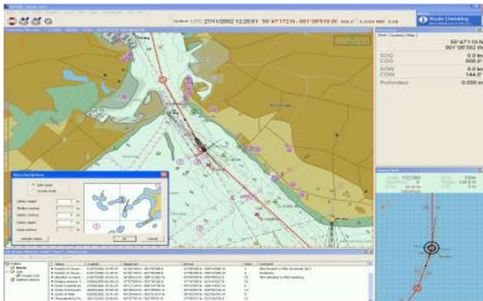
Figure III.5. Exemple d'un navire suivant une route à l'aide du logiciel ECDIS.
