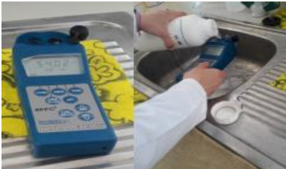
Figure III. 4: Appareil multi-paramètre [Photo prise au niveau de la station de dessalement de Mostaganem 2019]
