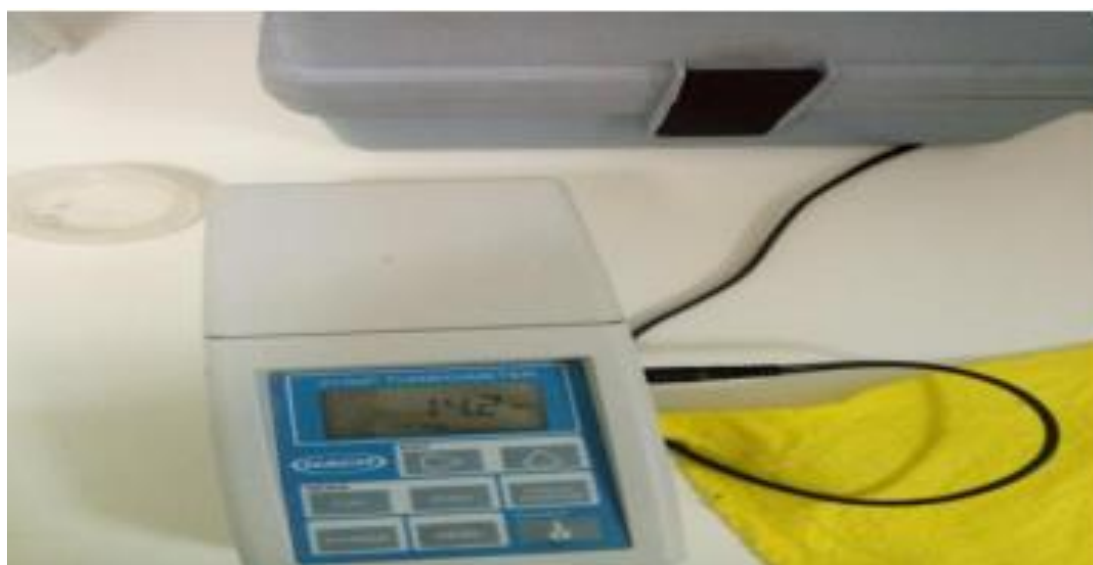
Figure III. 5: Mesure de la turbidité
