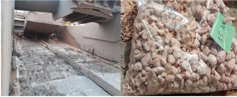
Figure 20 : Tamis vibrant avec les cuttings (sur chantier)
