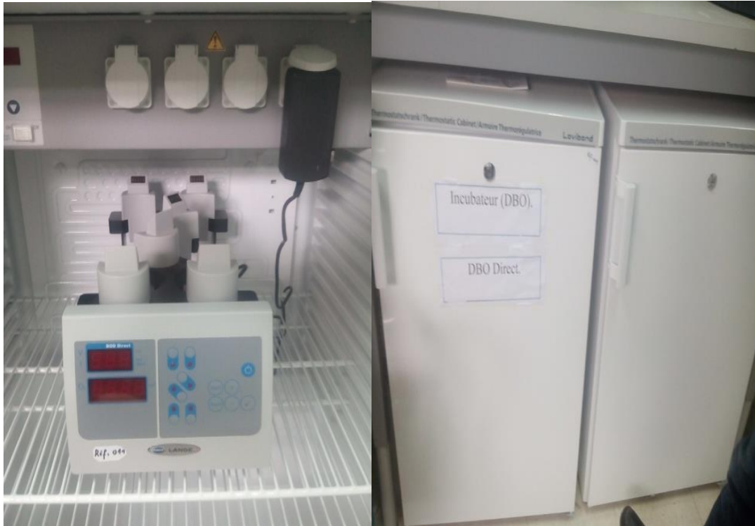
Figure44: Mesure de la DBO 5 utilisé au niveau du laboratoire de la STEP.
