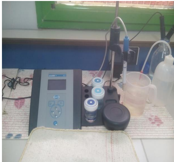
Figure 37: Conductimètre utilisé au niveau du laboratoire de la STEP
