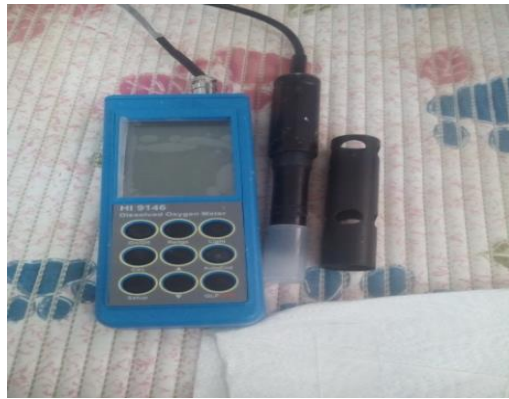
Figure 45: Oxymètre utilisé au niveau du laboratoire de la STEP.
