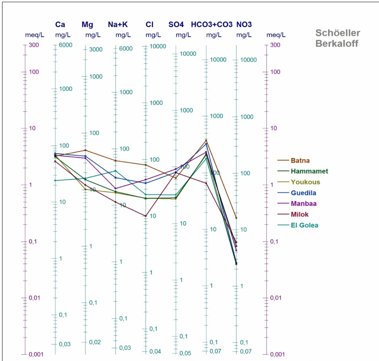
Figure 19: Représentation graphique des eaux sur le diagramme de Schoeler-Berkaloff.
