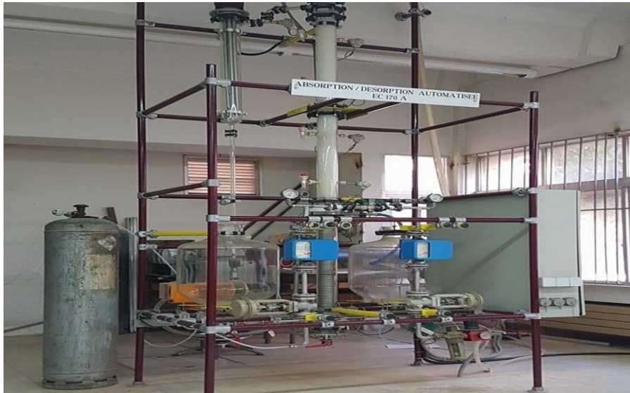
Figure VI.3. Pilote de l'absorption dans laboratoire USTO, MB.
