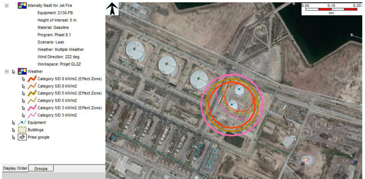
Fig. 3.6 : Scénario d’une fuite dans le bac 2130-FB suivi par un Jet Fire.
