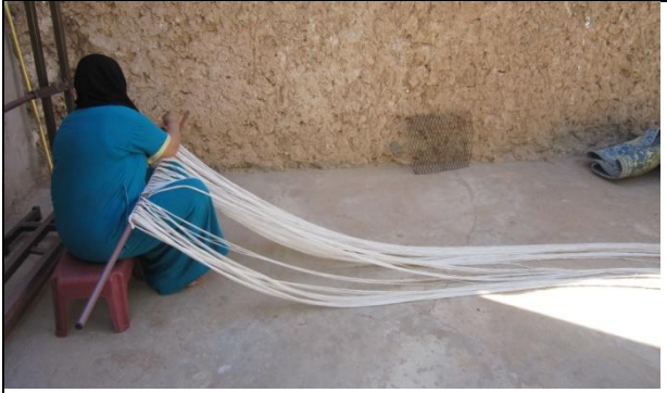
الصورة رقم (39): عملية تسدية الزربية (من تصوير الباحثة: متليلي الشعابنة أبريل 2016)
