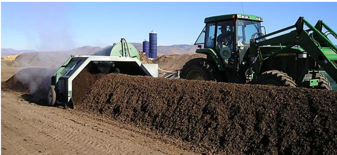
Figure 04 : Compostage en andains
