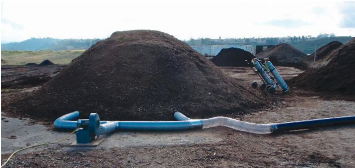
Figure 05 : Compostage en tas statique aéré mécaniquement
