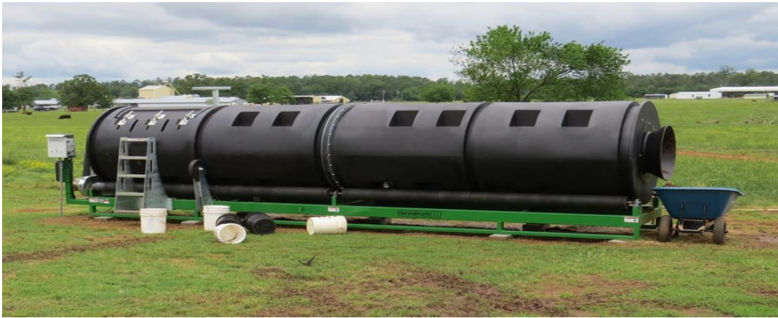
Figure 06 : Compostage en cuve fermée
