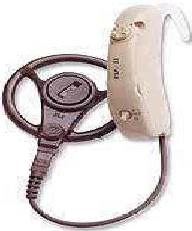
شكل رقم(4) يوضح الجزء الخارجي للقوقعة الإلكترونية.
