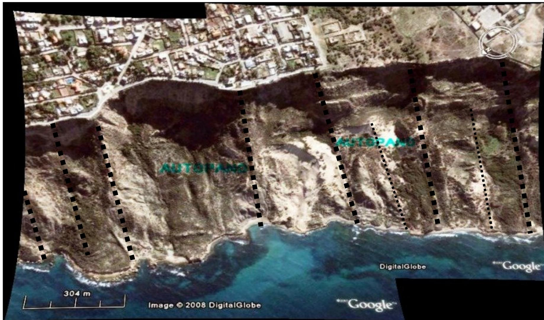
Fig. 226: Failles hypothétiques déduites de l'analyse de la forme des masses glissées (Au contrebas de Canastel)
