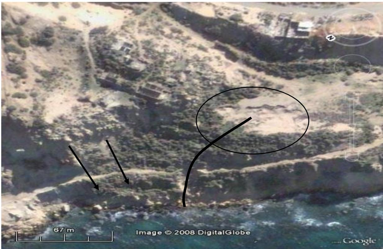
Fig.178 : Glissement et chute de blocs (cercle : tributaires à l'amont du glissement, flèche noire:sens du mouvement)
