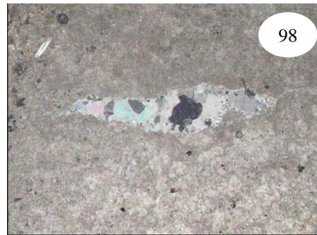
**c- Porosité vacuolaire.** Elle est représentée par des vides de forme très irrégulière et de taille variant de 300 à 1200  $\mu\text{m}$ . Elle abonde dans les termes supérieurs des séquences élémentaires tidales ainsi que dans les dolomies bioclastiques sus-jacentes de la deuxième séquence. Cette porosité résulte d'une dissolution (post-dolomitisation) de cristaux de grande taille et de vides préexistants (Ph. 99)
