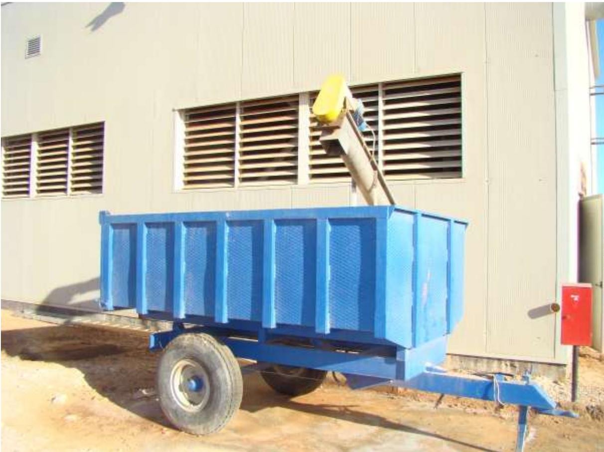
FIG 7 PHASE FINALE DU PROCESSUS DE RECUPERATION DES BOUES
