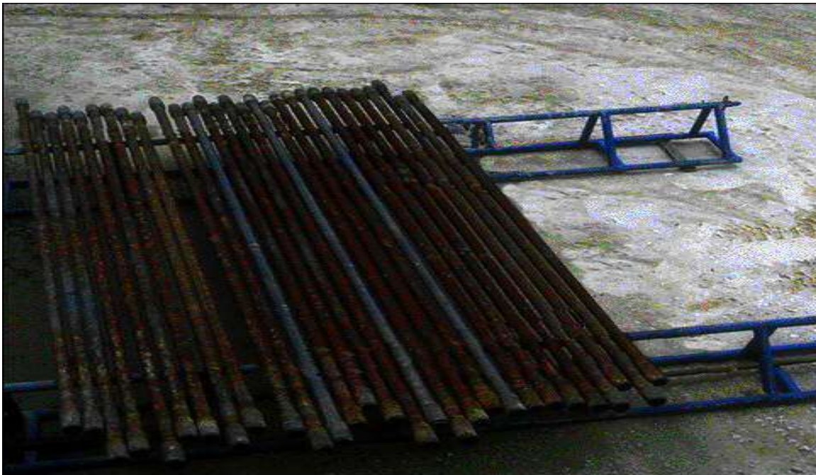
Photo N°5 : Les tiges de Forage.
