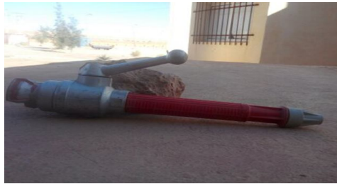
الشكل (7) نهاية الانابيب المخصصة لاستعمال المياه تحمي من التكهرب
