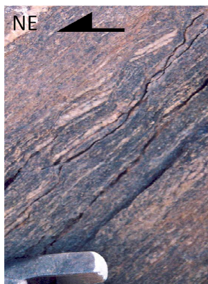
Figure VI-55 : Feldspaths cisailés par des plans C`.
