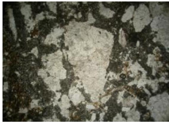
**Photo. 42 :** micrographie d'un calcaire marmorisé à fins granules de grenat dans un fond calcitique à structure granoblastique (LN x 50)
