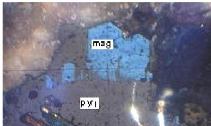
**Photo.49** : micrographie montrant des cristaux automorphes de magnétite. (L.R. x 80).
