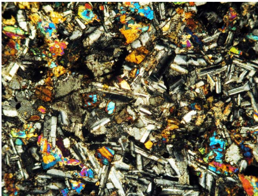
Photo 1 : Vue en lame mince de la diorite gabbroïque (échant. EG 46).
