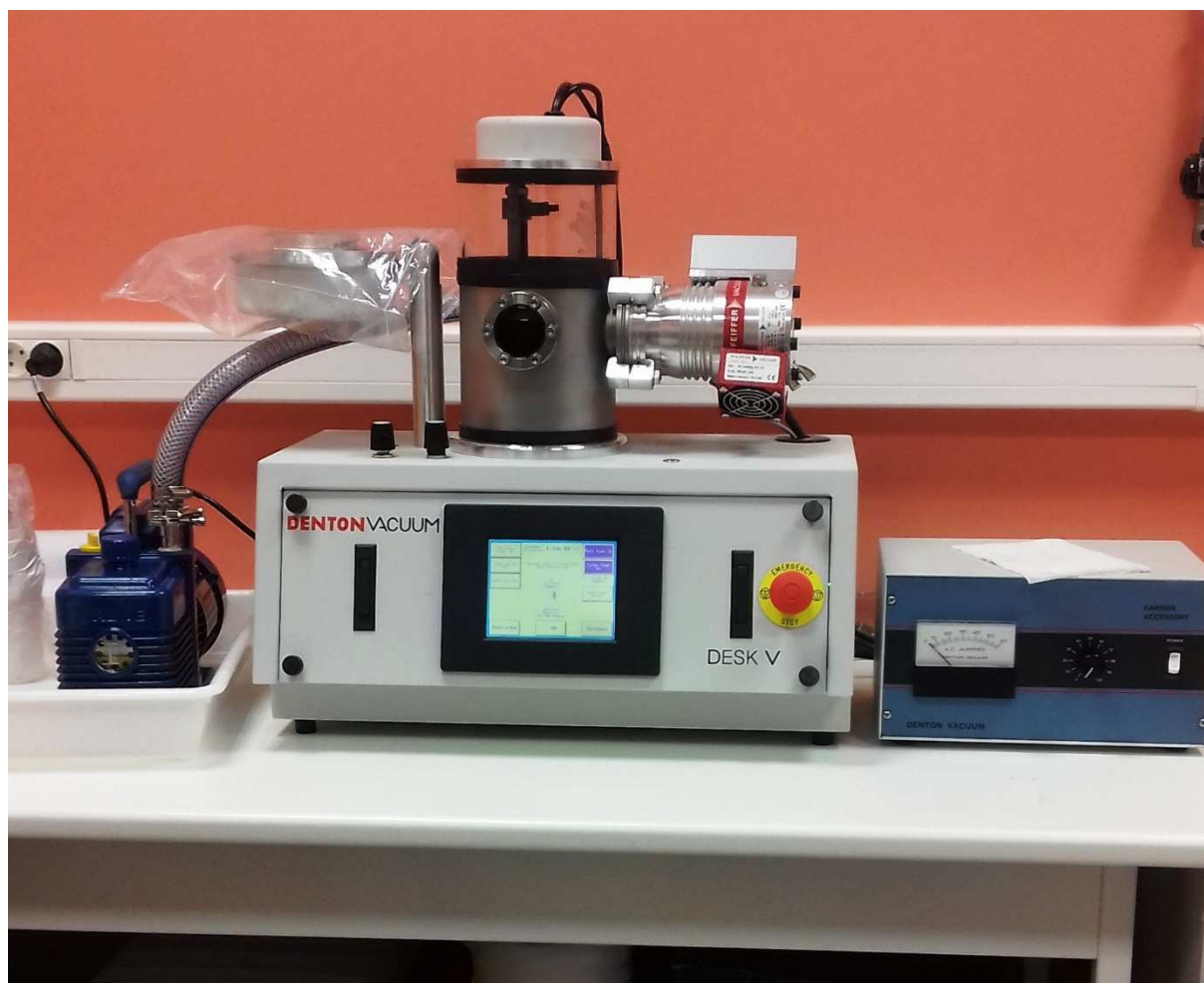
Fig. 2 : Evaporateur de carbone du Laboratoire Magmas et Volcans.
