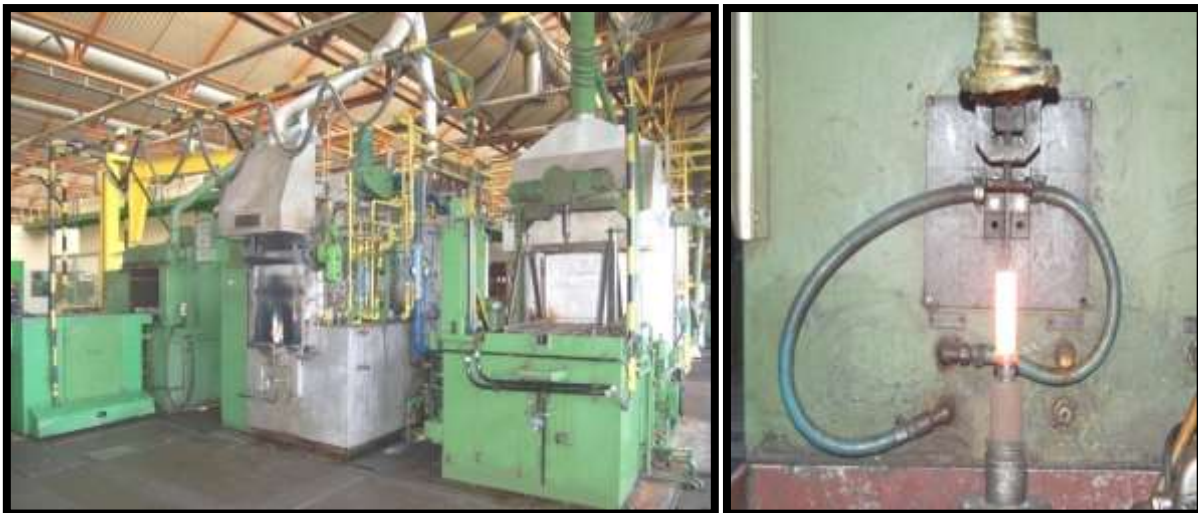
الشكل رقم (18): توضح عملية ضغط المادة الأولية بالحرارة
