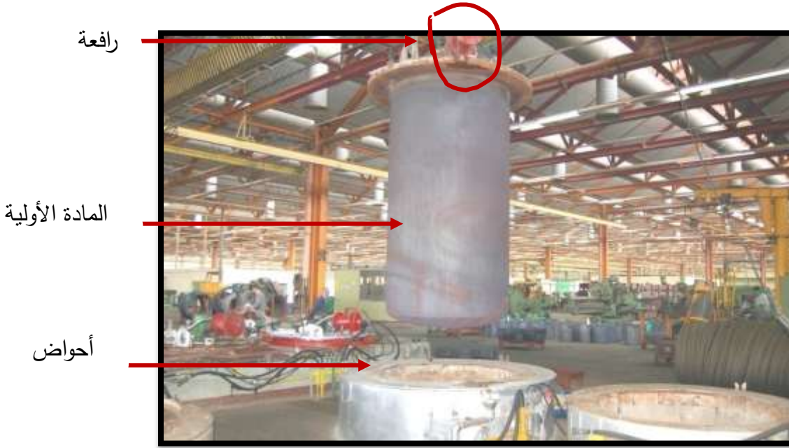
الشكل رقم (17): توضح خطر سقوط كتلة الحديد
