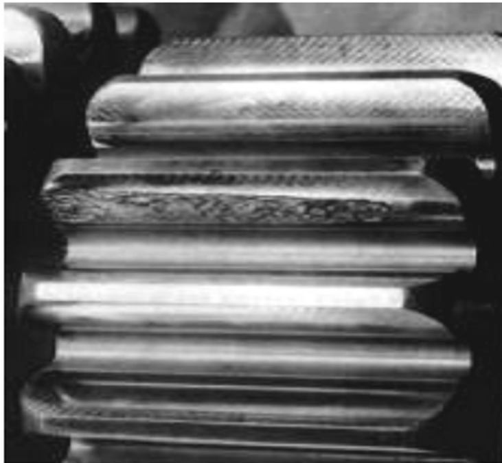
Figure 1.22. Pignon totalement écaillé [20].
