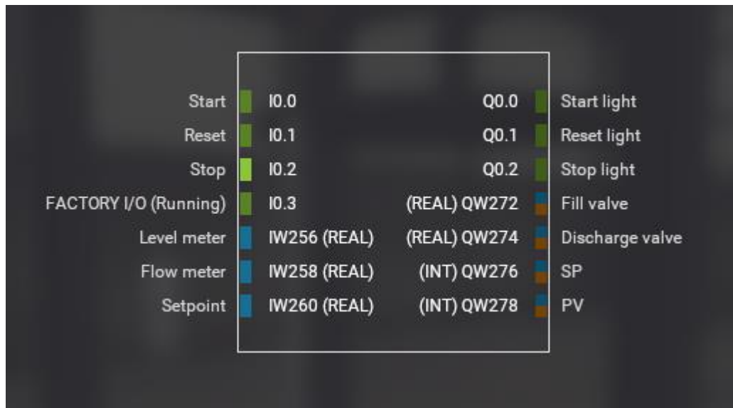
Figure IV.16 : Schema des I/O et Variable de Simulation dans Factory IO.
