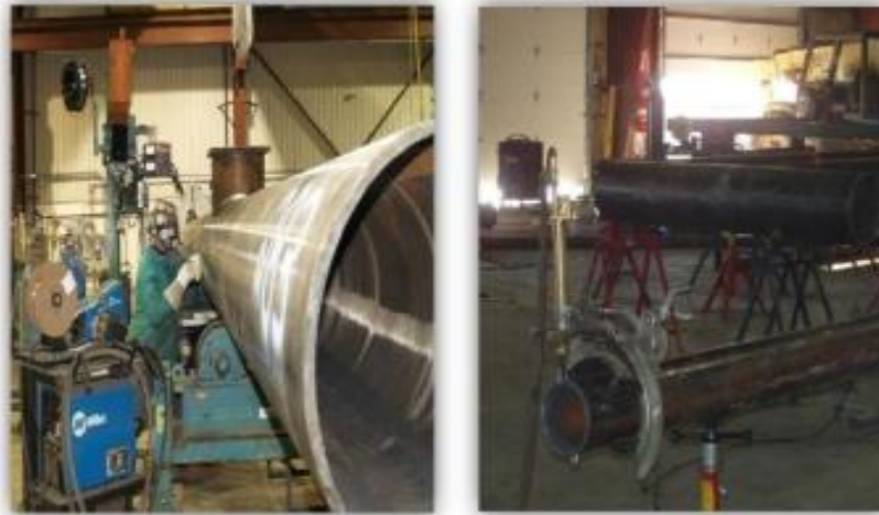
Figure[I-8] : Soudage manuelle et automatique des tubes
