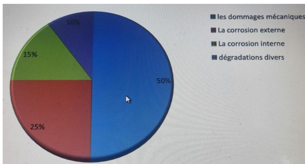
Figure[I-11] : répartition en pourcentage les défaillances des pipelines
