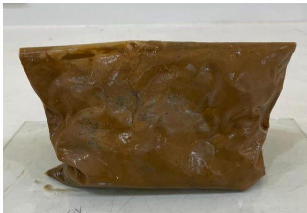
Figure 22 : échantillon de boue dilue prélevé du de bassin de décantation
