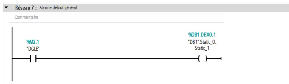
Figure IV.12 : blocs d'organisation_OB1_Alarme défaut général.
