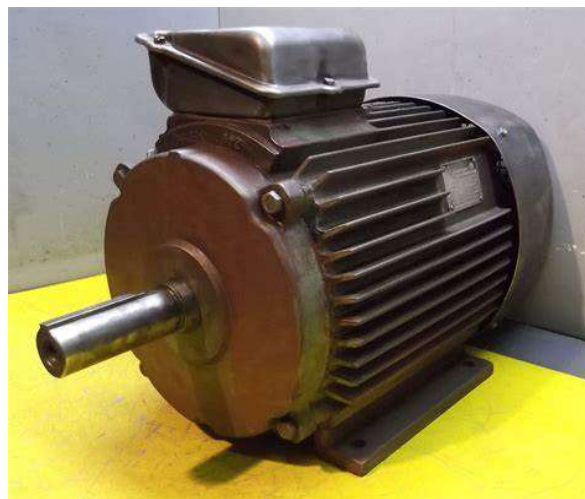
Figure II.23 : Moteur de la pompe d'eau de service
