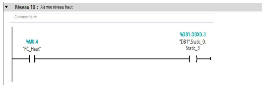
Figure IV.15 : blocs d'organisation_OB1_Alarme niveau haut.
