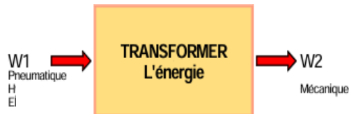
Figure II.34 Principe de fonctionnement d'un vérin pneumatique
