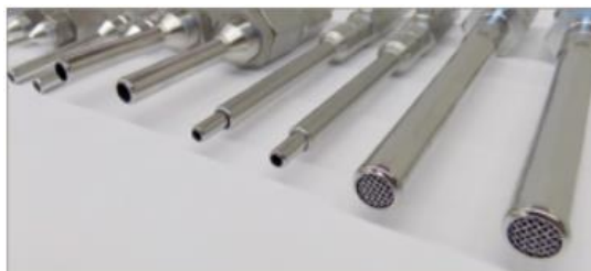
Figure II.55 Les buses utilisées dans les machines de remplissage
