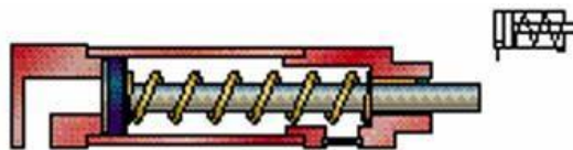
Figure II.35 Principe de fonctionnement et symbolisation d'un VSE avec tige rentrée au repos
