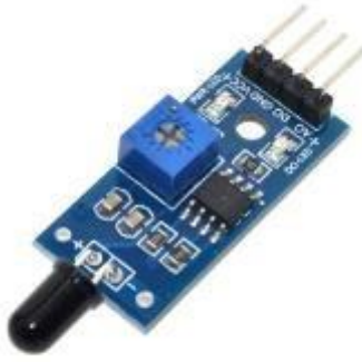
Figure 3.5 : capteur de flamme (LM 393) [18]
