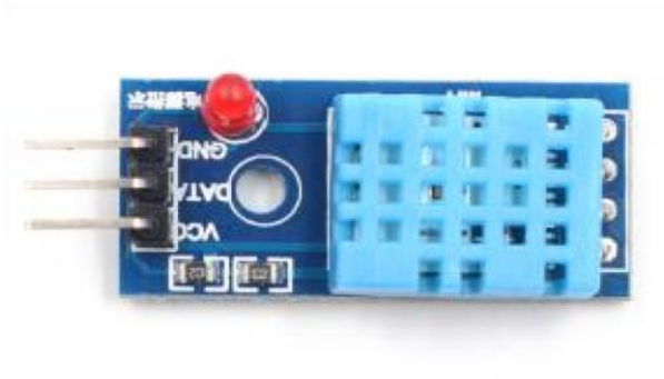
Figure 3.4 : capteur de température (DHT 11) [17]
