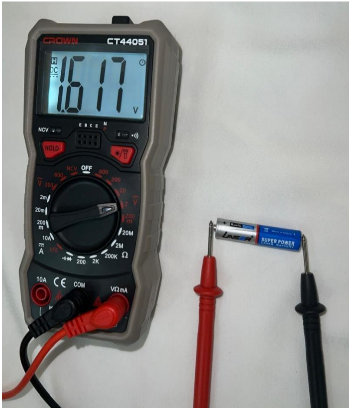
Figure VI.26 : La mesure de la batterie avec le multimètre Crown
