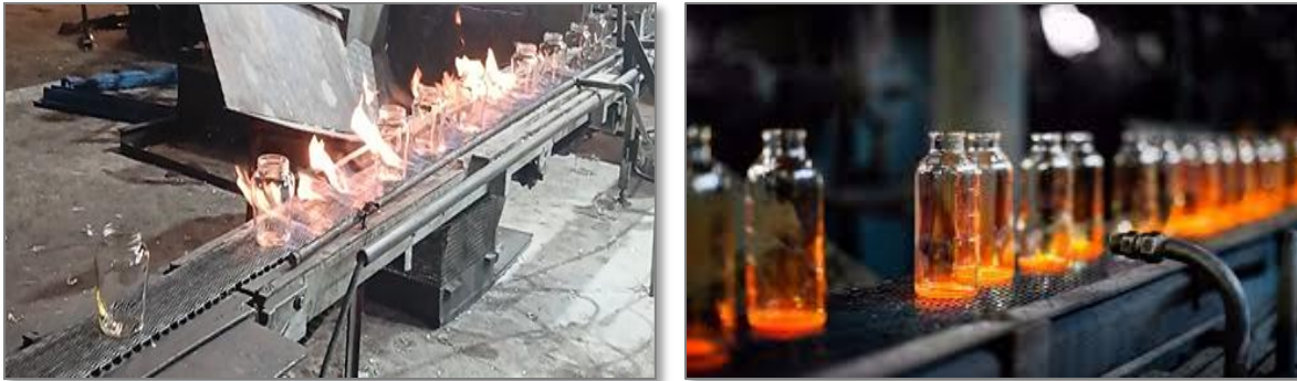
Figure 13 : traitement thermique de produit
