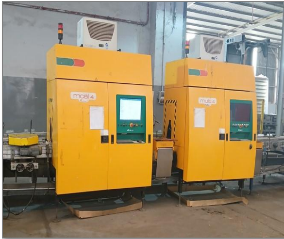
Figure 15: mcal4 et multi4] Machines de contrôle de la qualité
