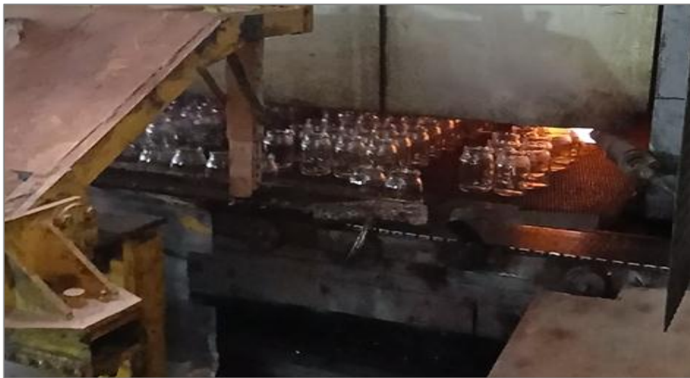
Figure 14 : image pris à l'entrée de l'arche de recuisson
