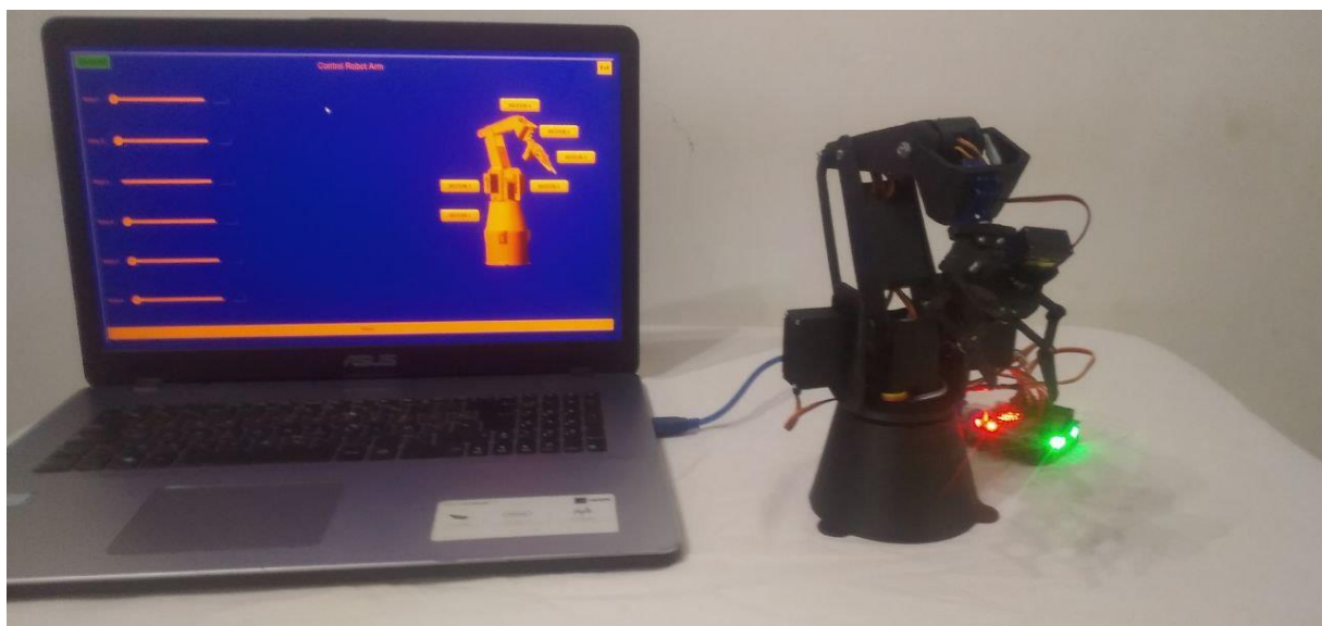
Figure 4-19 Assemblage complet du bras manipulateur
