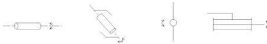
Figure 1-17 Représentation d'une articulation rotoïde
