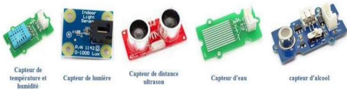
Figure 2-3 Différent types des capteurs pour l'arduino
