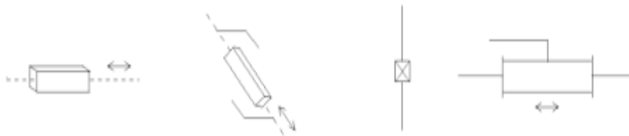
Figure 1-16 Représentation d'une articulation prismatique.
