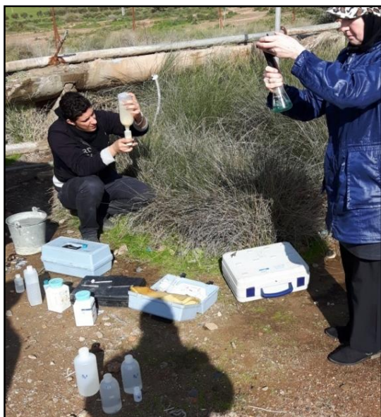
Photo 6 : A gauche : Préparation des échantillons et mesure de l'alcalinité au niveau de la source thermale Aïn El Bagra dans la région de Hammam Bouhdjar. A droite : Préparation du précipité de carbonate de bryum, pour l'analyse de l'isotope ^{13}\text{C} . Forage ADE, Ain Skhouna, – Saïda (Hadjou, Décembre 2016)
