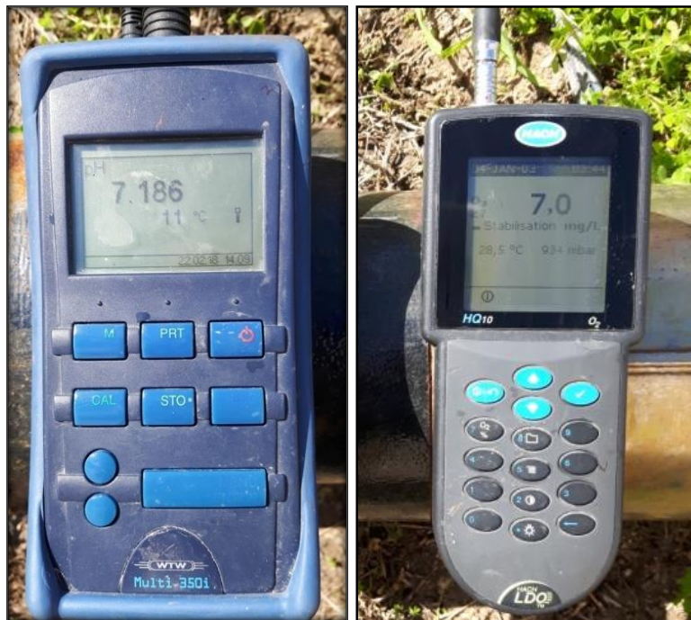
Photo 1 : Appareillages de mesure in situ : Température, pH, O 2 dissous, TDS (Hadjou, Décembre 2016).
