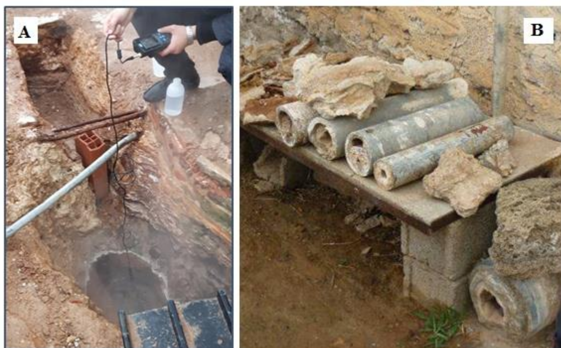
Photo 21 : A : mesure des paramètres physico-chimique au niveau d'un griffon. B : Entartrage des tubes de transports des eaux thermales ( Hadjou, 2016 ).
