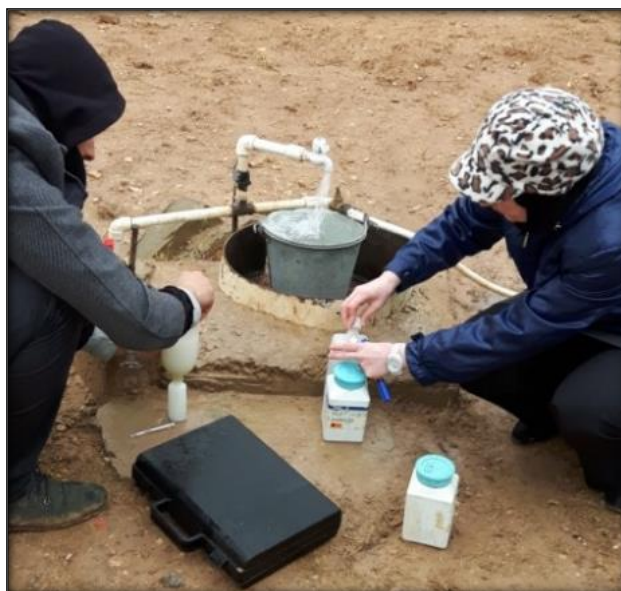
Photo 6 : A gauche : Préparation des échantillons et mesure de l'alcalinité au niveau de la source thermale Aïn El Bagra dans la région de Hammam Bouhdjar. A droite : Préparation du précipité de carbonate de bryum, pour l'analyse de l'isotope ^{13}\text{C} . Forage ADE, Ain Skhouna, – Saïda (Hadjou, Décembre 2016)
