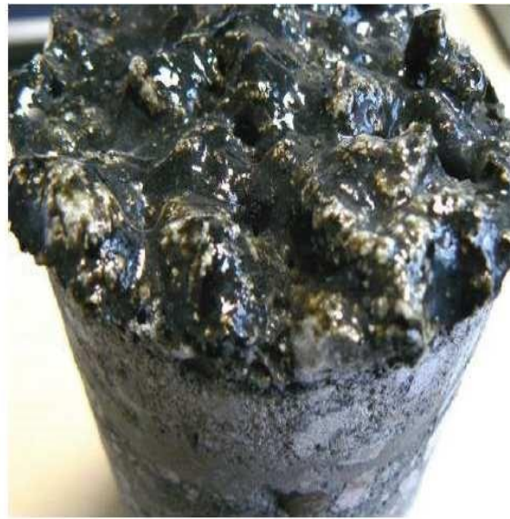
Figure 2. 5 À gauche, observation au MEB de la pâte de ciment durcie d'un béton après un incendie selon (30), à droite cliché d'une carotte prélevée dans une dalle en béton après 2 heures (34)
