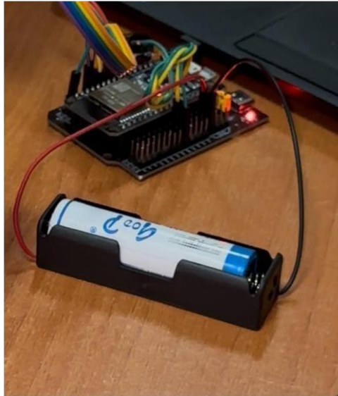
Figure III.8 : Branchement de la batterie
