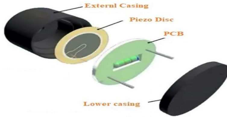
Figure II.7 : Intérieur d'un buzzer actif
