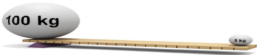
figure I-7 Schéma de levier mécanique.
