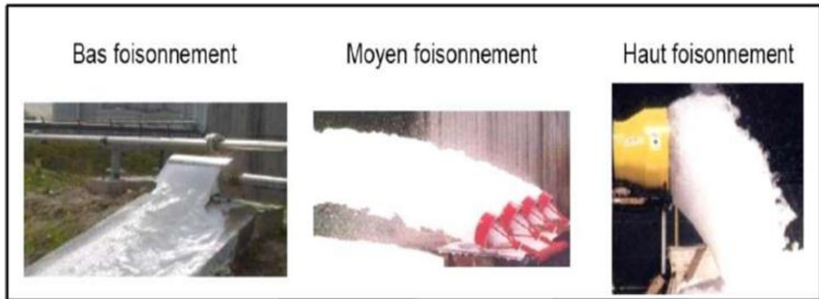
Figure 2.15 Différents types de foisonnement de la mousse [10]
