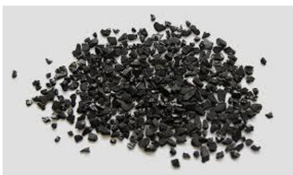
Figure 4: Charbon actif granulé.
