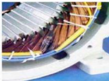
d) Dégradation causée par une surtension
