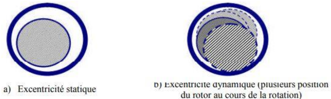
Fig.I.7. Schématisation de l'excentricité statique et dynamique.
