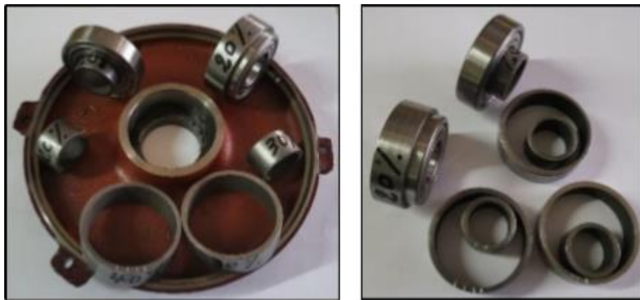
III. 10. Mécanisme de création du défaut d'excentricité. [6]
