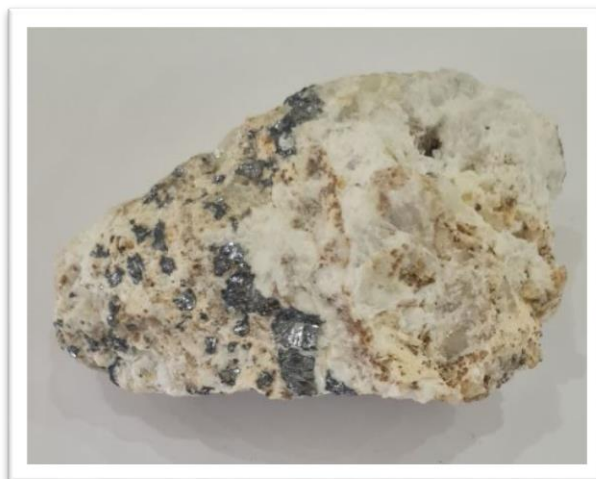
Figure 18 - Présence de traces de sulfures métalliques : galène ( \text{PbS} ).
