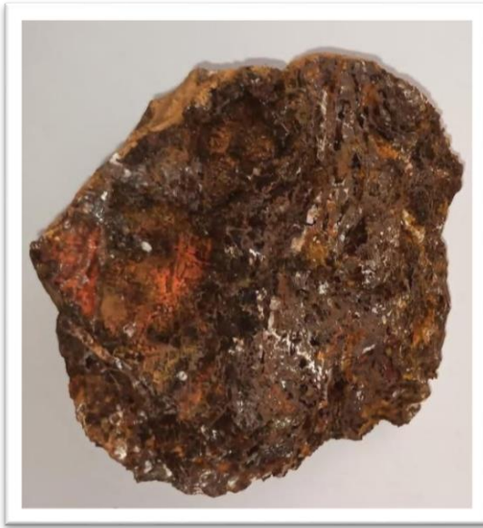
Figure 19 - Phénomène d'oxydation des minéraux de fer observé sur l'échantillon.
