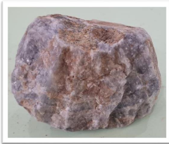
Figure 17 - Échantillon de baryte associé à de la calcite et de la dolomite altérées.
